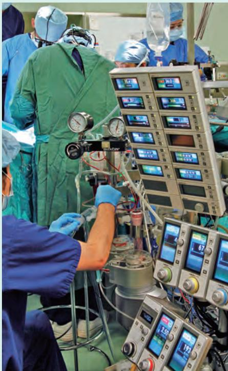
榊原記念病院では人工心肺装置の開発に尽力してきた。国内市場では初となる小型の分離型ポンプを開発し、小児心臓手術成績の飛躍的な進歩に貢献した。写真は、「HAS II人工心肺装置」。コントロール部とポンプ部を完全に区分し、移動やポジショニングを向上させたもので、安全・短時間な小児心臓手術を目指し続けてきた。
